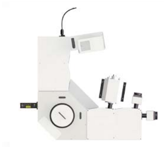
FLS980稳态及时间分辨(ps – μs –TCSPC)光谱仪，光谱范围可到1700nm。配置EPLs和ELEDs作为时间分辨测试光源，通过样品仓的激光入口接入。超连续光源连接到双光栅激发单色器一侧。
